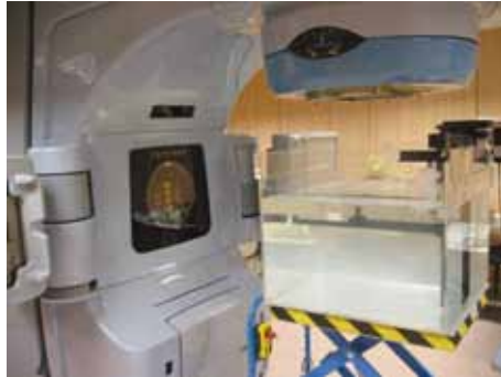
Figura 3. Tanque de agua de un sistema analizador de haces automático (ICO-SFMPR).
