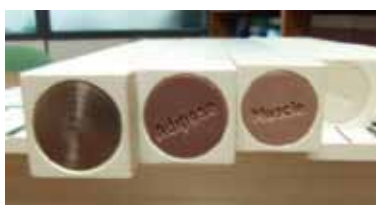
Figura 8. Detalle del maniqué, donde se visualizan diferentes tipos de tejido (ICO-SFMPR).
