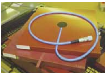
Figura 6. Cámara de ionización insertada en una lámina de agua sólida (ICO-SFMPR).
