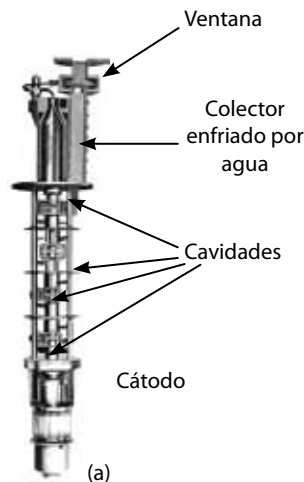
Figura 9. Klystron con 4 cavidades. Adaptada de (Karzmark y Morton, 1981), con permiso.
