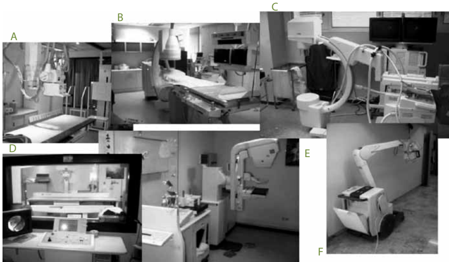
Figura 3. Distintas configuraciones de equipos de rayos X: A: equipo convencional; B: arco intervencionista; C: arco radioquirúrgico; D: telemando; E: mamógrafo; F: Equipo portátil.
